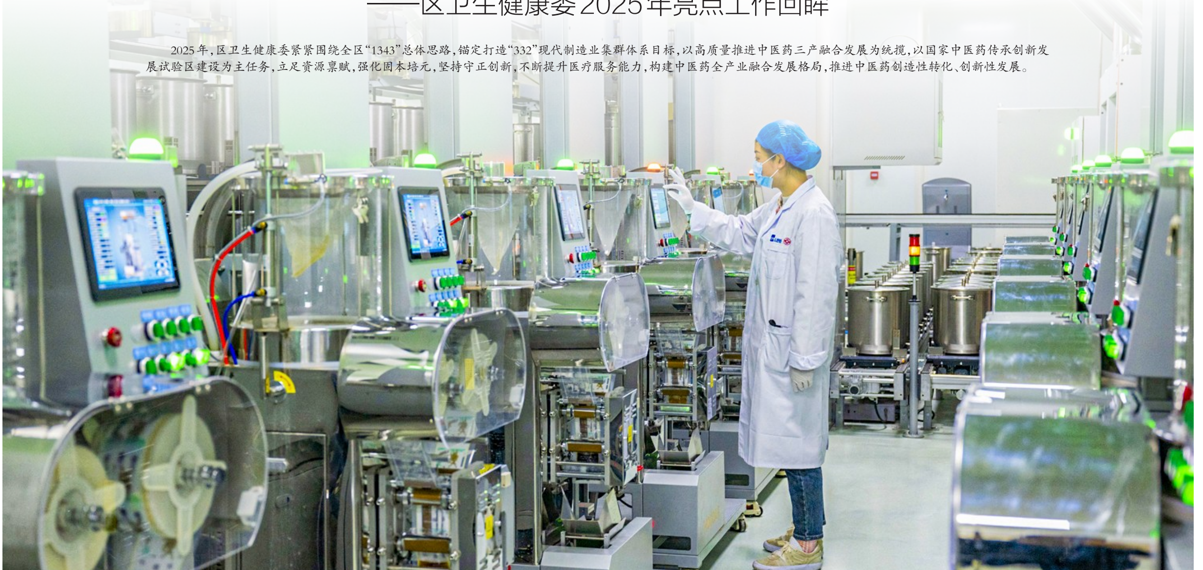
重庆上药慧远庆龙药业有限公司的生产车间内,一个个煎药桶正通过传送带,进行自动熬药、包装、清洗等工作。
